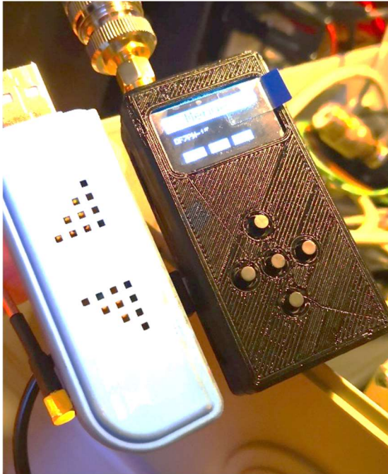
Das Lora-APRS-Gateway (rechts) zum Größenvergleich neben einem DVBT-Stick.
